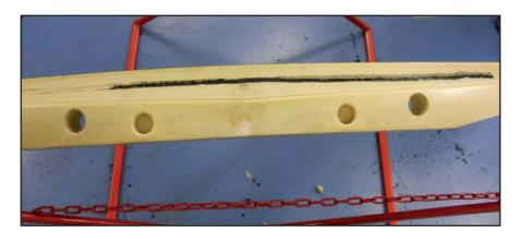
In corrispondenza della misura dei sensori, forare il supporto anti vibrazione utilizzando una fresa da 35 mm.
