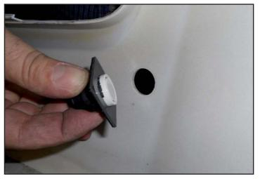
In corrispondenza della misura dei sensori, forare il supporto plastico posteriore utilizzando una fresa da 35 mm.
