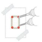
Fissare la dima di carta con del nastro adesivo da carrozziere e forare come descritto con una punta da 5 mm.
